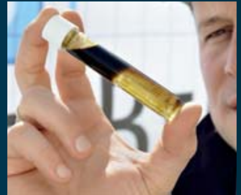
PROBE AUS DEM UNTERGRUND: AUF DEM GRUNDWASSER SCHWIMMT ÖL.
