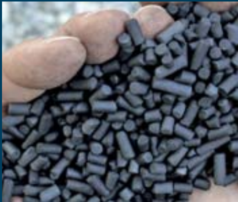
DIE FILTER SIND MIT INSGESAMT 120 TONNEN AKTIVKOHLE GEFÜLLT.
