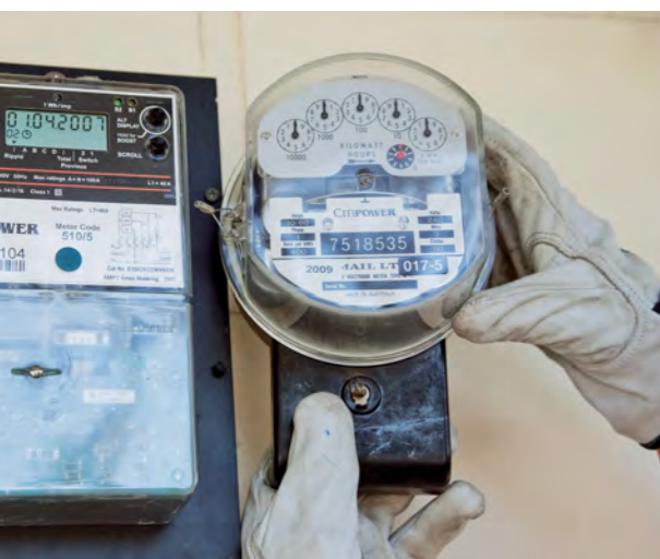
DIE ALTEN ZÄHLER WURDEN VIERMAL IM JAHR ABGELESEN. DIE NEUEN GERÄTE SENDEN DIE VERBRAUCHSDATEN IM 30-MINUTEN-TAKT AN DIE SCHALTZENTRALE DES ENERGIEVERSORGERS.
