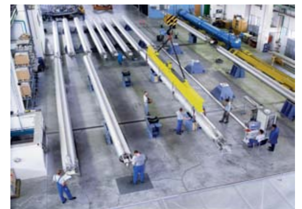
PASSGENAU MÜSSEN DIE 15 METER LANGEN DIPOLMAGNETE ZUSAMMENGEBAUT WERDEN, DAMIT SIE SUPRALEITEND WERDEN.
